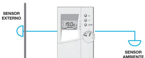
El software hace uso del sensor de la unidad externa para calcular el punto de ajuste del agua de acuerdo con las condiciones de la temperatura exterior.
