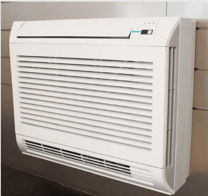
K2 está equipada con DCM (motores DC). En stand-by consume sólo 75 mW (milésimos de vatio) y está dotada de un sensor de humedad que sirve para modular la temperatura según el índice de temperatura percibida o para limitar el máxima porcentaje de humedad relativa ambiente. Además, como se puede deducir de la figura, los dos ventiladores son accionados de manera diferencial para optimizar la difusión del aire según el modo operativo, en refrigeración o en calefacción.
